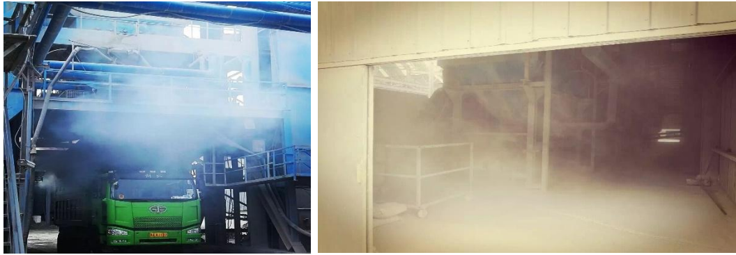
图 1 早期沥青混合料生产过程中沥青烟气和扬尘排放
