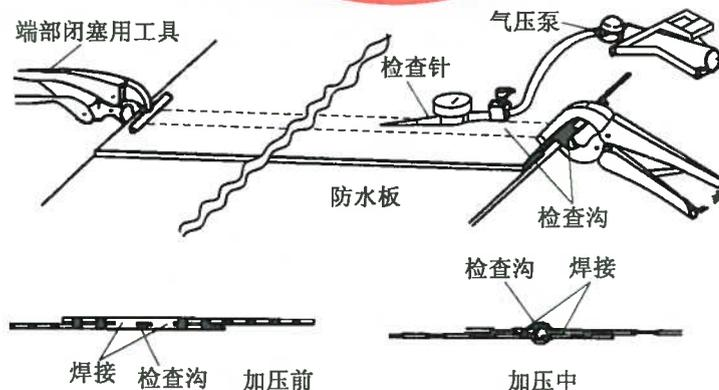
图 S.0.2 充气法检查焊缝质量示意图
