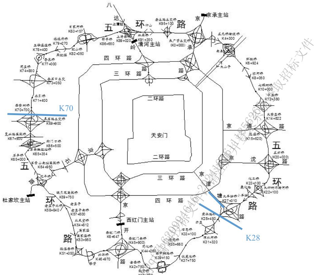
1. 北京市五环高速公路位于北京市市区边缘，距中心 10-15km，道路等级为高速公路，承担着城市快速路的功能。五环路建成于 2000-2003 年，按照高速公路设计，双向六车道，设计速度 100km/h，高速公路编号 S50，路线全长 98.6km，共有桥梁 325 座，涵洞 65 座。
