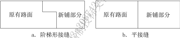
图 6 横向接缝的型式示意图
