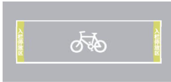
图 5 互联网租赁自行车停车设施标线
