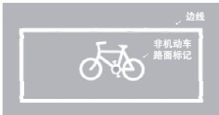
图 3 非机动车停车设施标线
