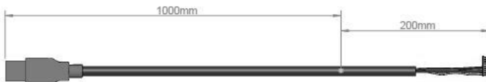
图 5 RS232 和 RS422 接口线缆的长度要求
