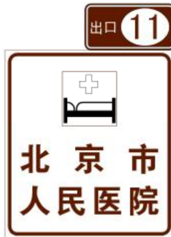
图3 高速公路单柱式版面示例
