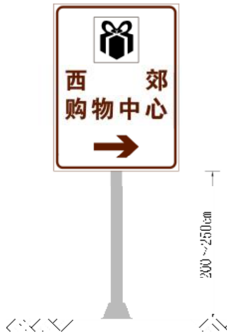
图13 单柱式标志安装高度示意图
