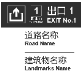
图37 出口周边道路和建筑信息标志示例
