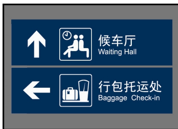
图57 导向标志组合设置示例 2
