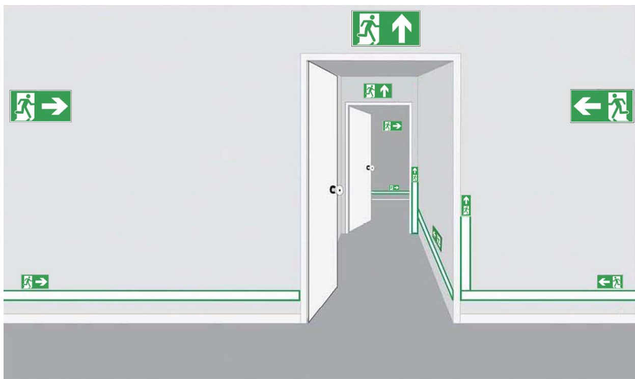
图16 疏散路线标志设置示例
