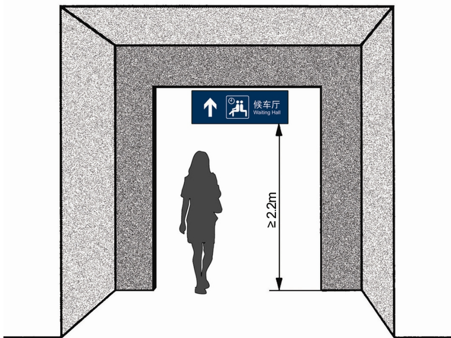
图15 标志悬挂安装时设置高度示意图
