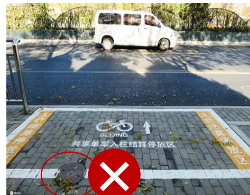
盲道等无障碍设施及其两侧各0.25m范围内不应设置非机动车停车区
