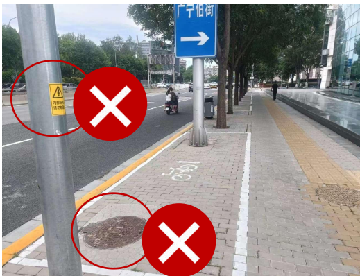
盲道等无障碍设施及其两侧各0.25m范围内不应设置非机动车停车区
