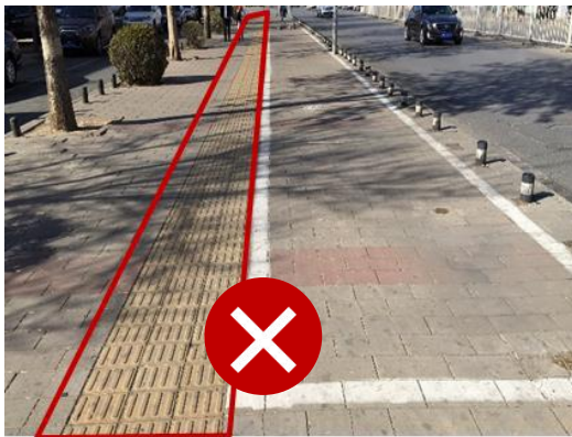
盲道等无障碍设施及其两侧各0.25m范围内不应设置非机动车停车区
