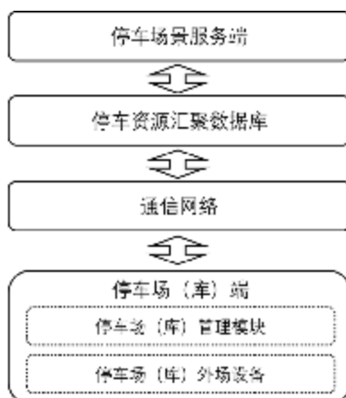
图1 智慧停车系统总体架构
