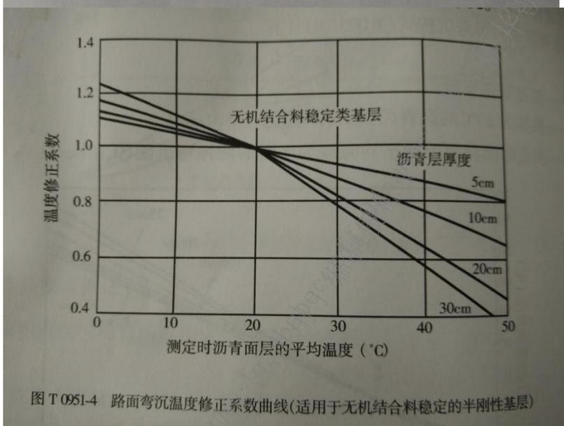
图 T 0951-4 路面弯沉温度修正系数曲线(适用于无机结合料稳定的半刚性基层)
