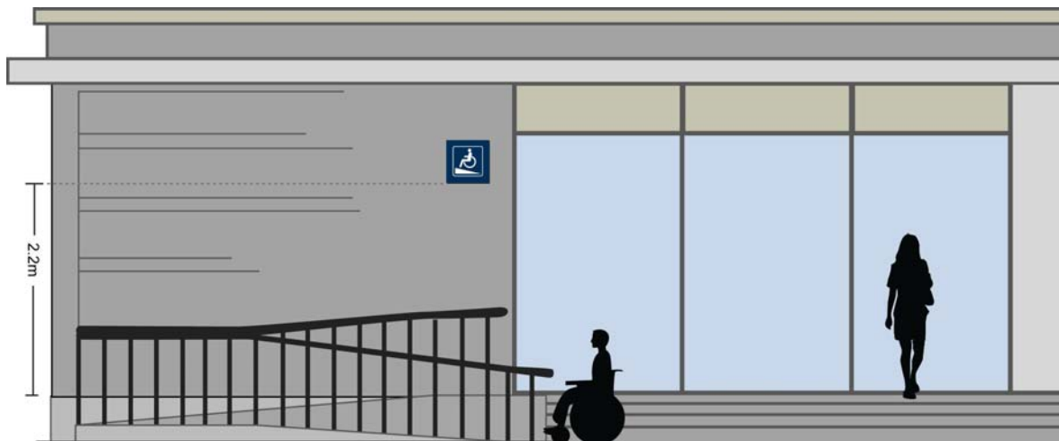
图29 无障碍坡道标志设置
