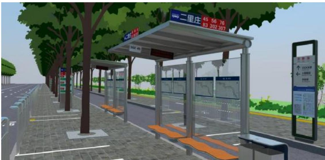
图A.3 二类站台示意 1（外侧分隔带宽度 $\geq 2.5\text{m}$ ）
