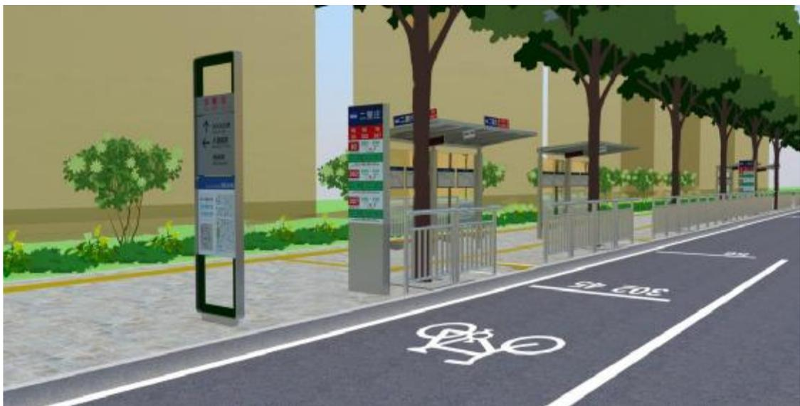
图 B.4 二类站台示意 2（站台宽度 $\geq 2.5\text{m}$ ）
