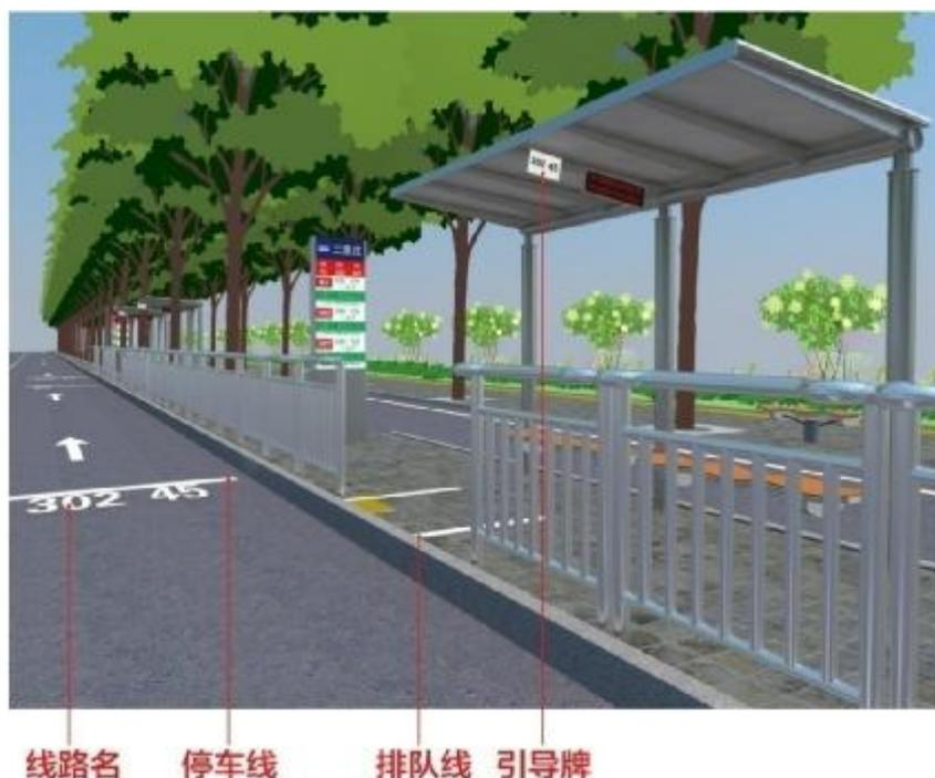
图2 站台排队及车辆停靠引导标识示意
