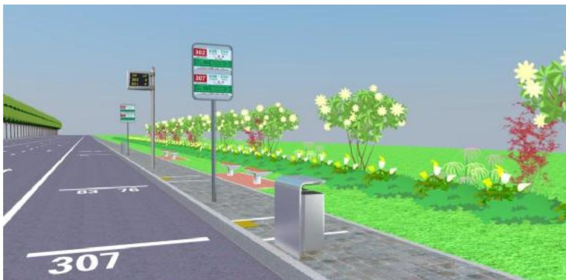
图 B.9 四类站台示意 1（路侧带宽度 $\leq 2\text{m}$ 、无候车亭-城区）
