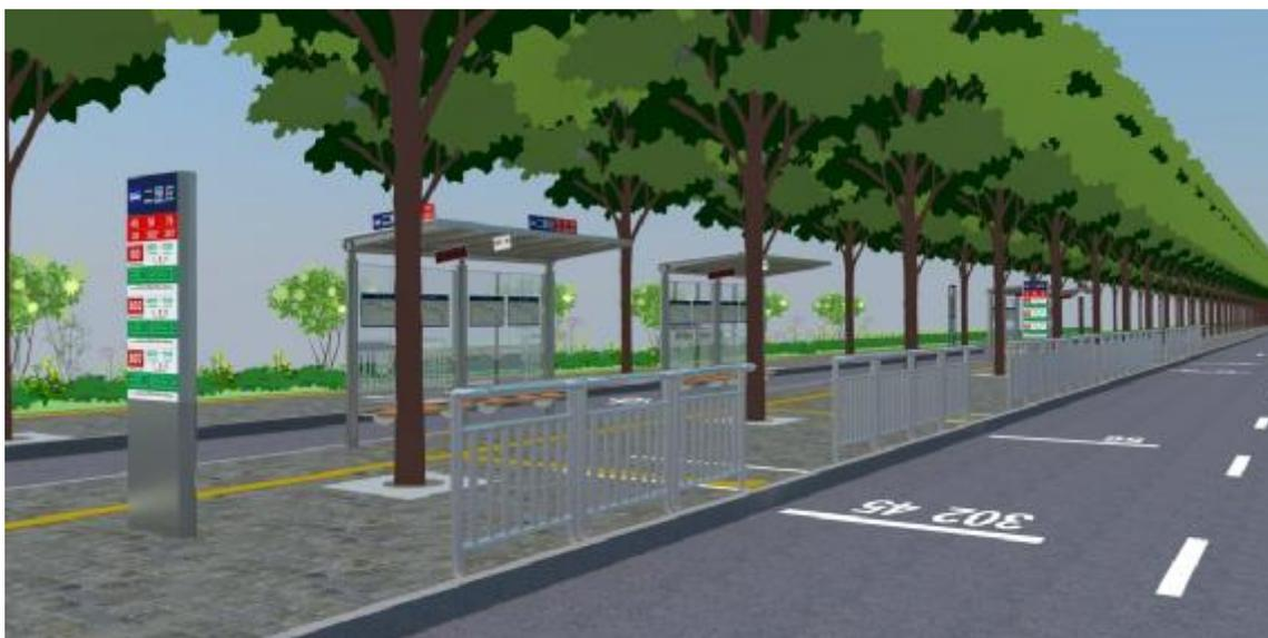
图A.2 一类站台示意 2（外侧分隔带宽度 $\geq 6\text{m}$ ）
