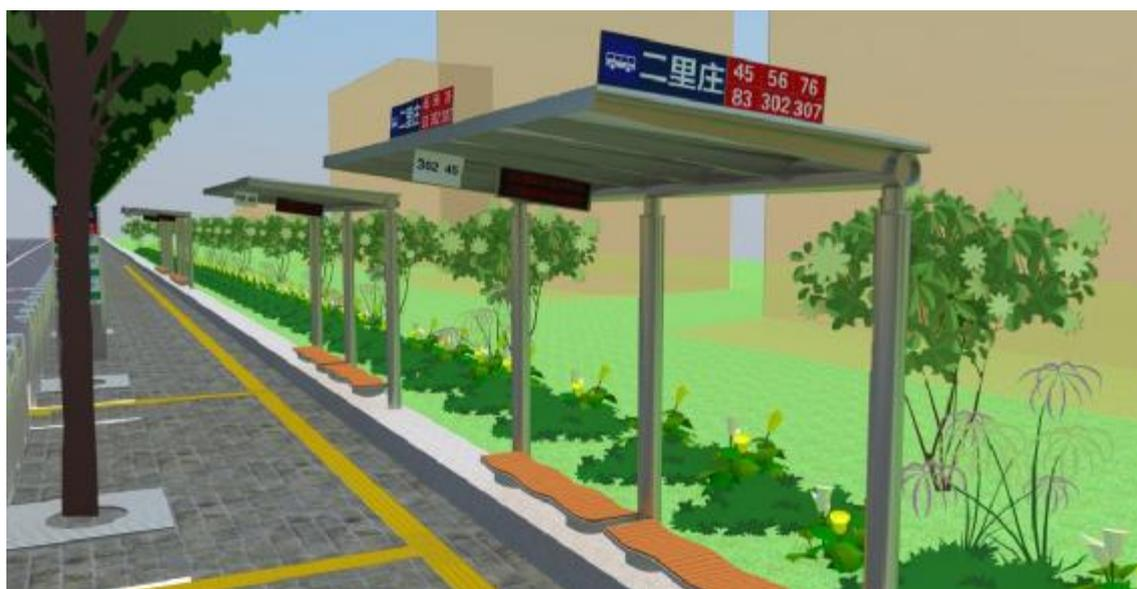
图 B.5 三类站台示意 1（结合路侧绿化带形式）
