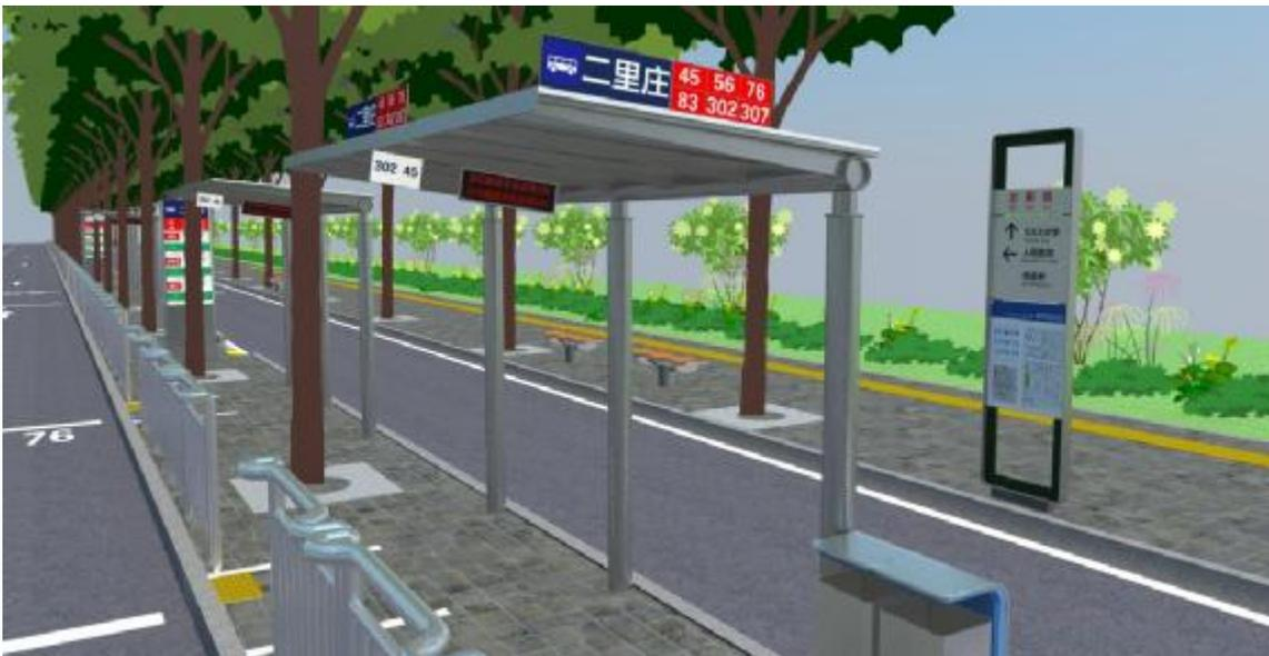
图A.5 三类站台示意 1（ $1.5\text{m} < \text{外侧分隔带宽度} < 2.5\text{m}$ 、无挡板候车亭型式）
