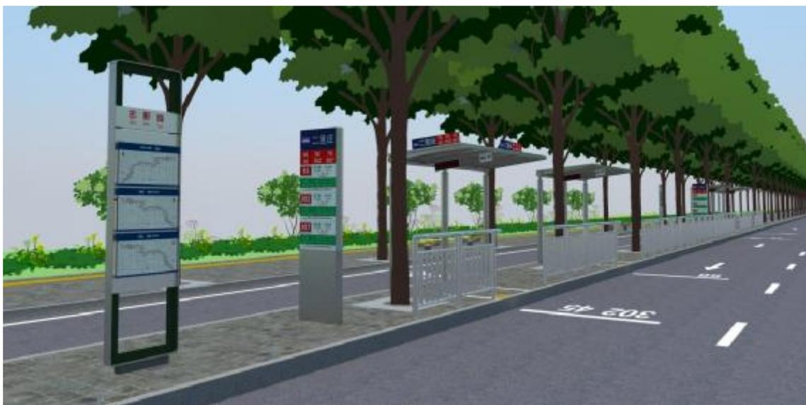
图A.6 三类站台示意 2 (1.5m<外侧分隔带宽度<2.5m、无挡板候车亭型式)
