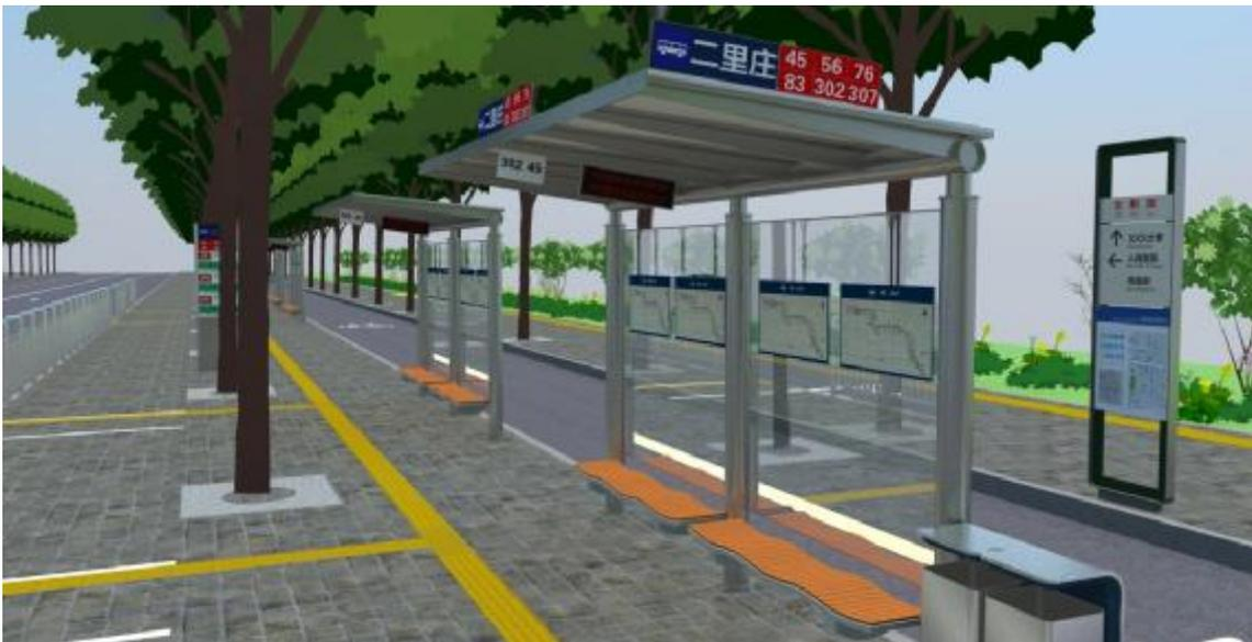
图A.1 一类站台示意 1 (外侧分隔带宽度 $\geq 6\text{m}$ )
