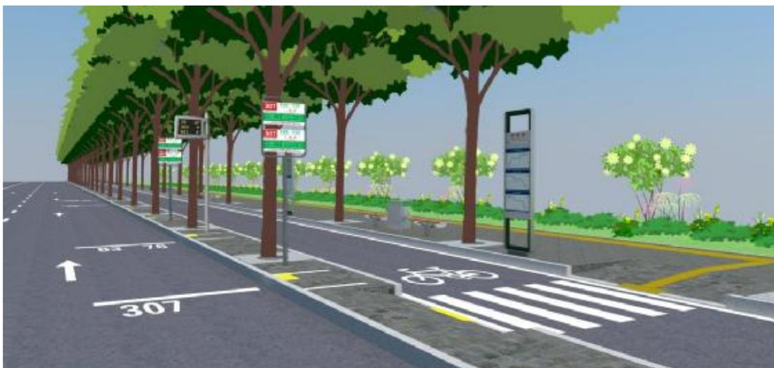
图A.7 四类站台示意 (外侧分隔带宽度 $\leq 1.5\text{m}$ 、无候车亭型式)
